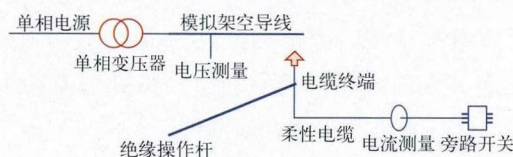
图13 空载旁路电缆断接试验示意图
