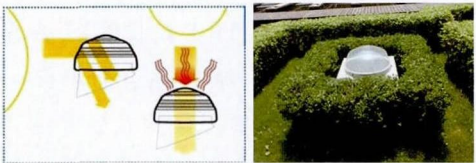
图4 被动式光导照明系统原理
