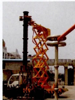
图1 基于绝缘支撑装置巡检机器人系统
