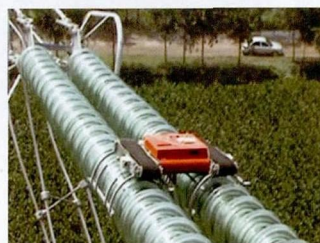
图2 耐张双串绝缘子检测机器人检测系统
