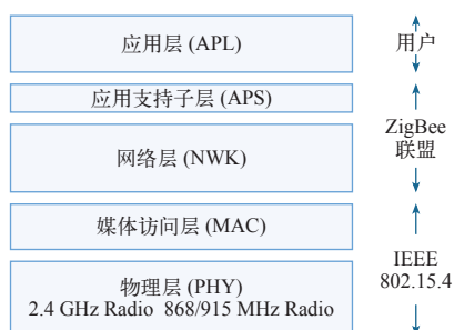
图2 ZigBee协议栈结构
