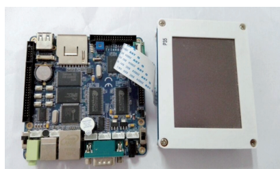
图4 基于ARM7的控制系统调试样板
