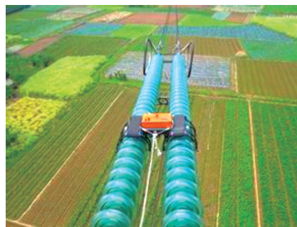
图2 履带移动式绝缘子检测机器人工作示意图
