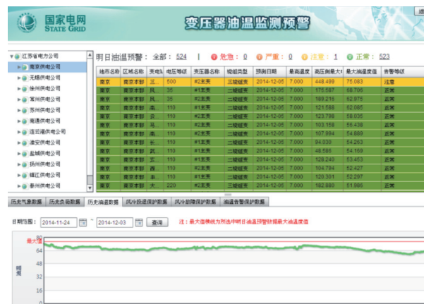
图6 江苏电网变压器油温监测预警系统用户界面
