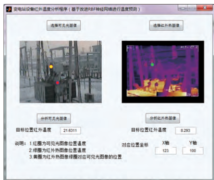
图7 设备红外温度分析程序界面
