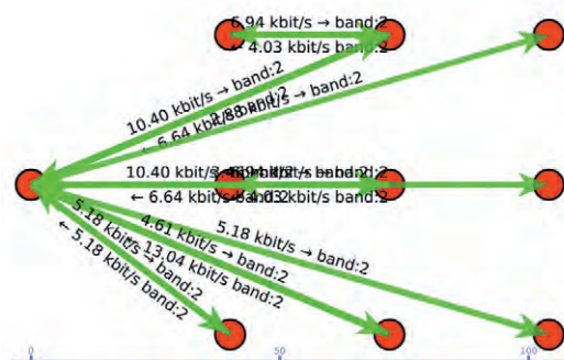
图3 多频通信测试 (工作频率组: 1号、2号和3号频率)
