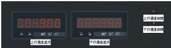
图5 频率升至定值区间，故障报警灯灭
