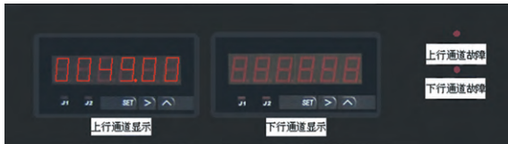
图5 频率升至定值区间，故障报警灯灭
