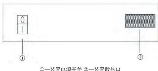
图2 装置后面板设计
