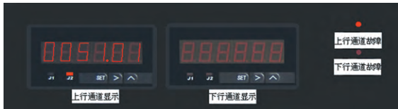
图6 频率超出定值区间，再次故障报警
