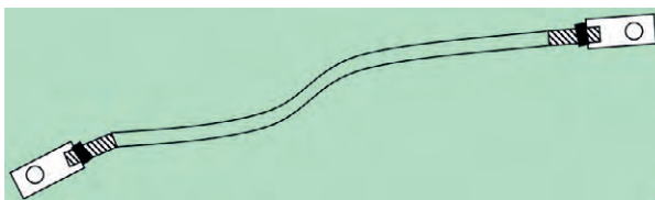
b 拉杆螺纹部位弯曲
