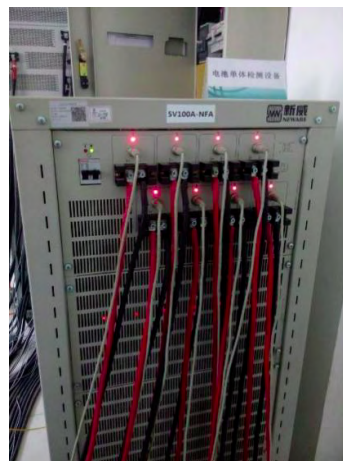
图5 5 V 100 A新威锂电池倍率放电测试柜
