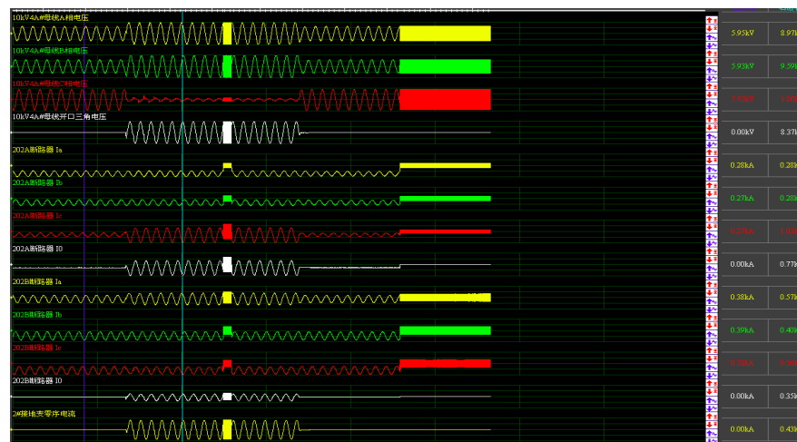
图 2 10 kV 4A# 母线和 202A 开关故障录波图
