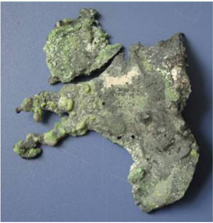
图3 屏蔽罩烧损后的残留物
