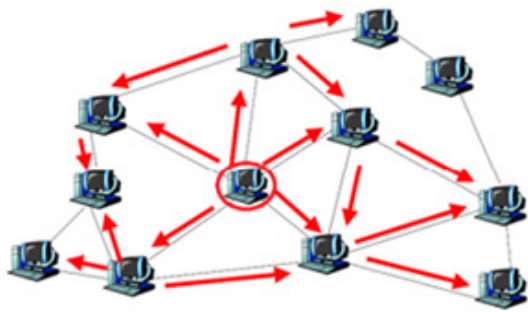
图5 洪泛路由示意图
