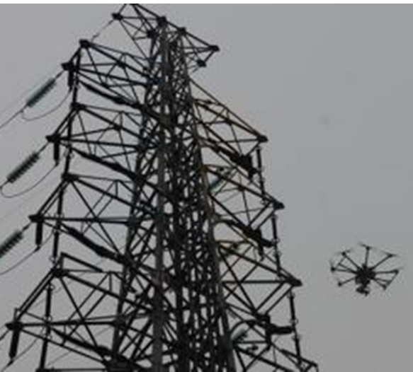
图2 多旋翼无人机进行精细化巡检
