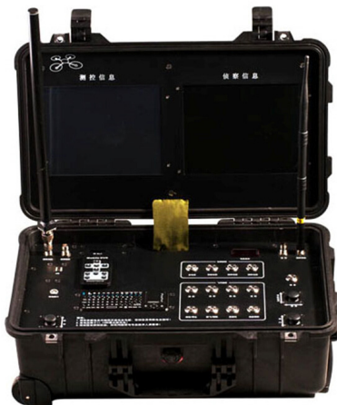
图7 无人机地面测控站实物
