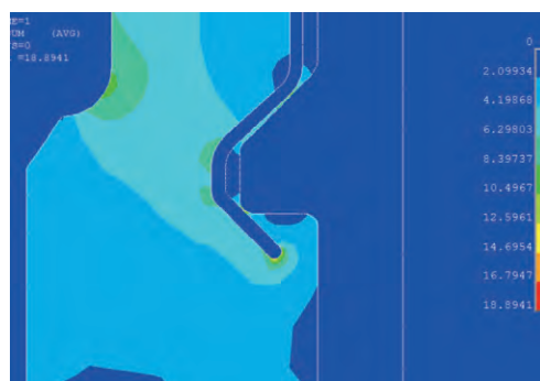
图9 瓷壳台阶固定主屏蔽罩电场分布
