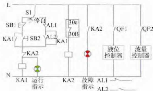
图3 自动补水控制电路图
