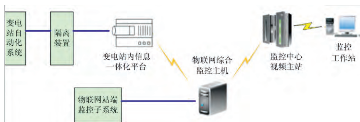
图1 变电站智能顺控系统逻辑结构图
