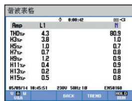
图9 采用过零投切电采暖控制器谐波测量值
