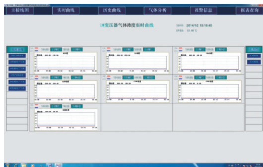
图6 1#变压器油中气体浓度—电流实时曲线
