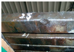
图7 受损伤的定子线圈 图8 通风槽片硅钢片受损情况
