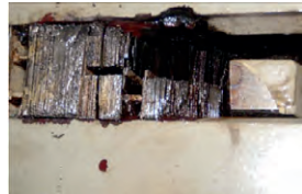
图6 定子铁心受损情况
