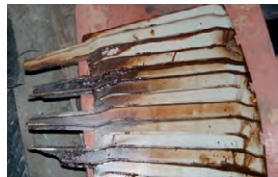
图7 受损伤的定子线圈 图8 通风槽片硅钢片受损情况
