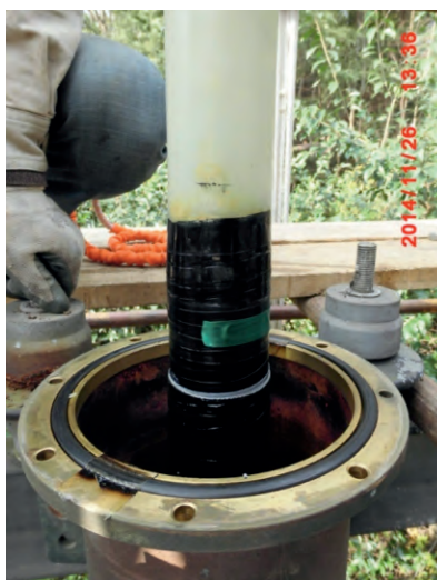
图5 110 kV聚驼线B相电缆终端解剖照片
