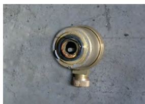
图3 14#空冷器断裂的排气阀接头
