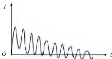
图2 典型的励磁涌流波形
