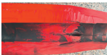
图8 炸裂的预制件内部
