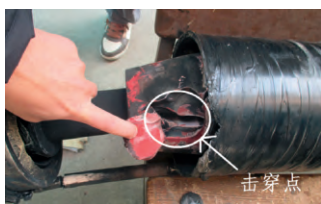
图3 故障接头击穿点
