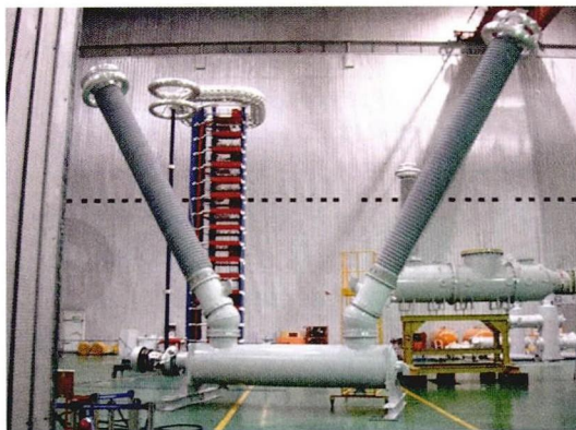
图13 550kV CB绝缘型式试验极
