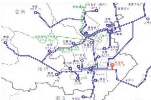
图3 规划末期110 kV变电站网络示意图
