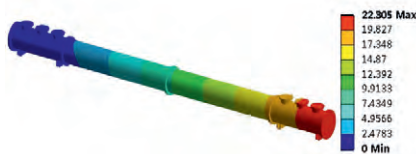
(a) 一端固定而另一端自由滑动时母线筒体的变形量
