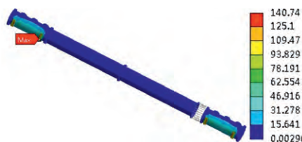
(b) 安装力平衡波纹管时母线筒体的应力分布
