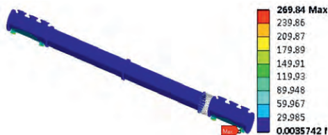
(b) 安装波纹管时母线筒体的应力分布
