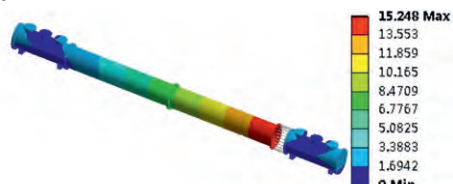
(a) 安装波纹管时母线筒体的变形量
