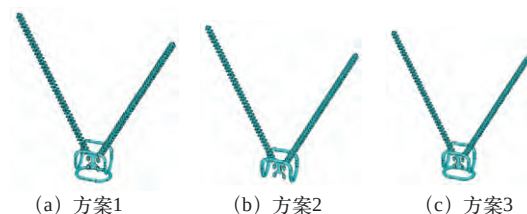
图3 绝缘子串金具结构改进图
