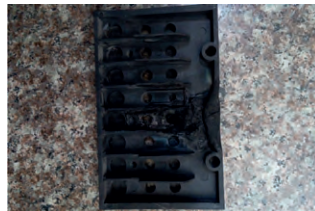
图4 烧坏的二次端子绝缘板
