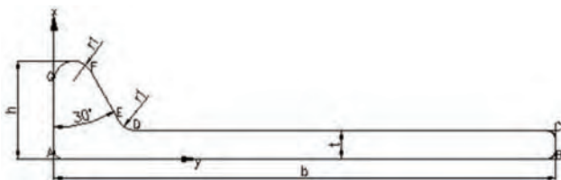
图1 球扁钢截面形状及尺寸参数
