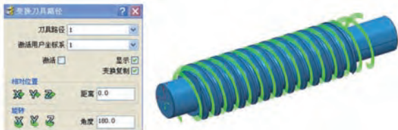
图 18 变换刀具路径
