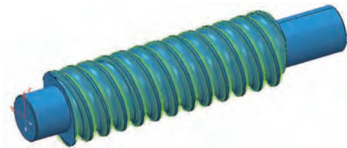
图 20 复制变换刀具轨迹
