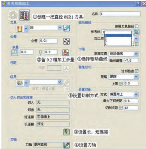
图 17 设置刀具路径参数
