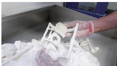
利用粉末选择性激光烧结 SLS 技术制造 Miller 91 赛车模型的部件
