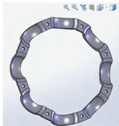
图 4 保持架实体模型
