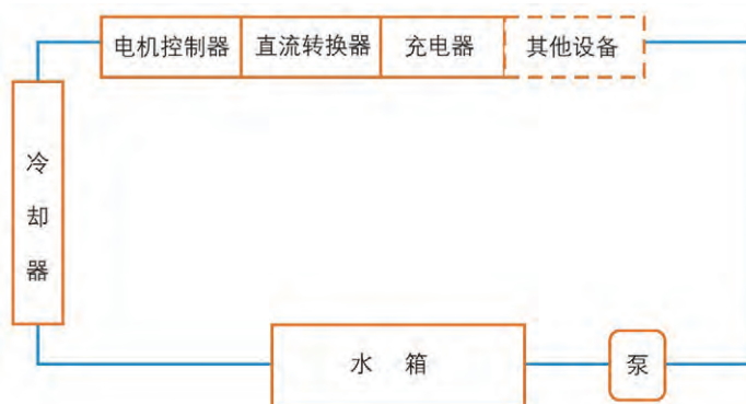
图 1 汽车液体冷却系统中的串联连接
