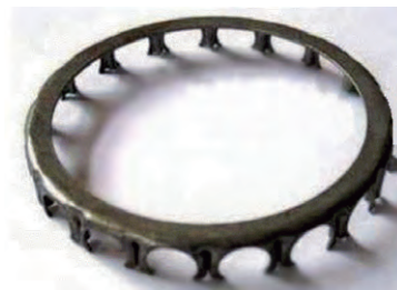
图 8 试制葵形保持架成品
