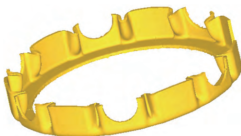
图 1 葵形保持架结构图
