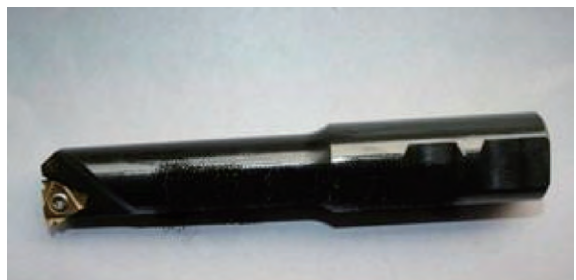
图 3 60° 镶刀片式单刃螺纹铣刀
