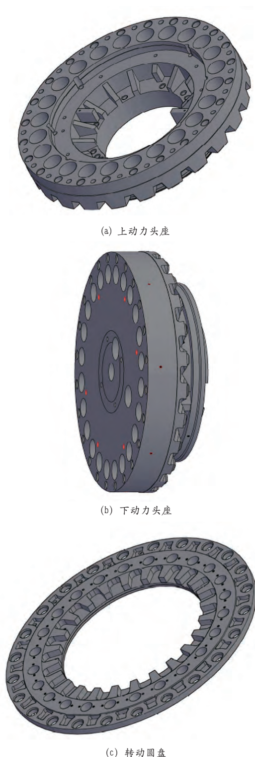
图2 “三明治”机构零件结构图
