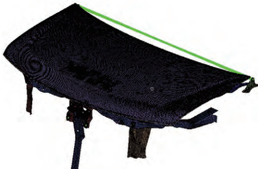
图 1 引擎盖关闭过程的有限元分析模型
