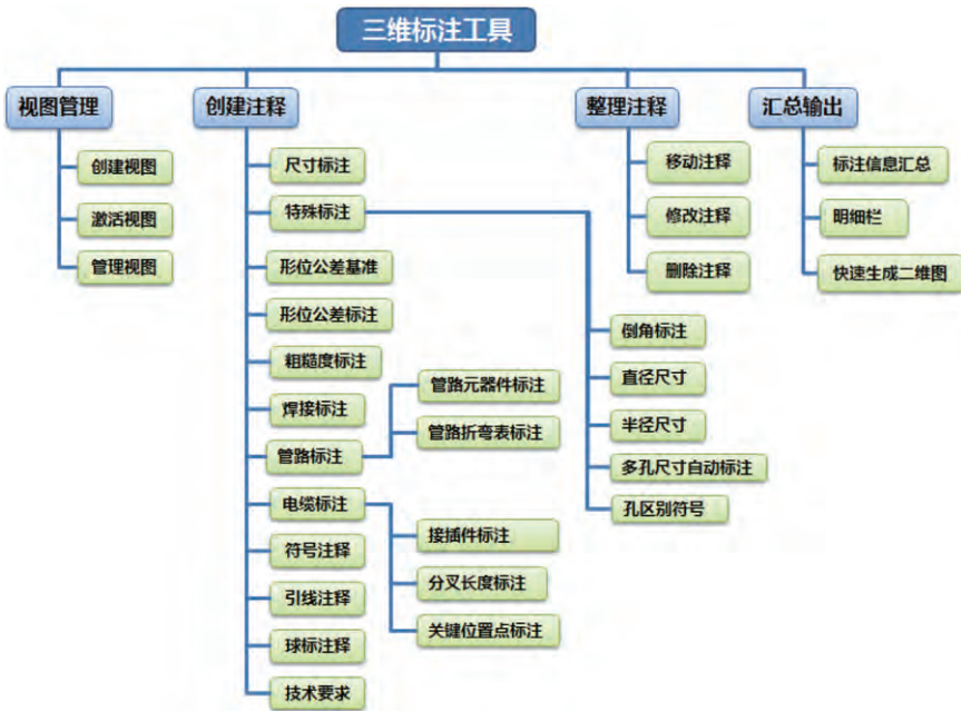
图 2 基于三维 CAD 软件的定制化三维标注工具
