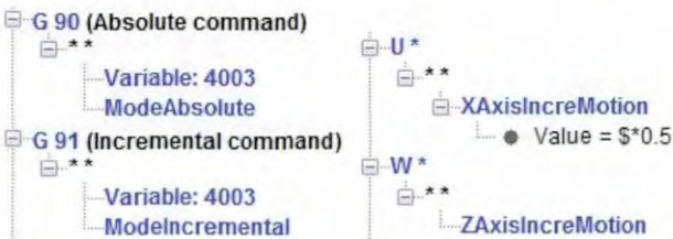
图 1 G90/ G91 G-Code Processing 代码设置
