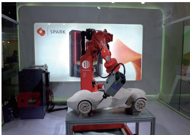
欧特克旗下 DelcamPowermill 软件编程驱动机器人进行油泥模的加工，精度、效率都大幅度超过手工油泥模
