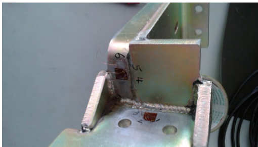
图 10 改进结构虚拟应变花位置
