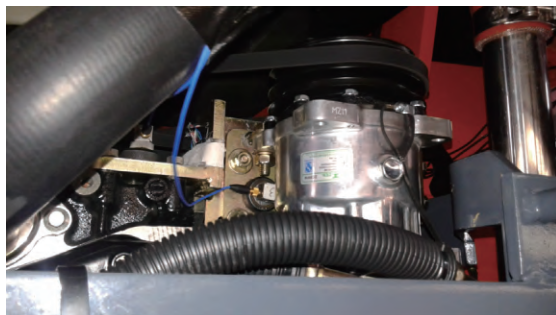
图 2 加速度传感器测试位置
