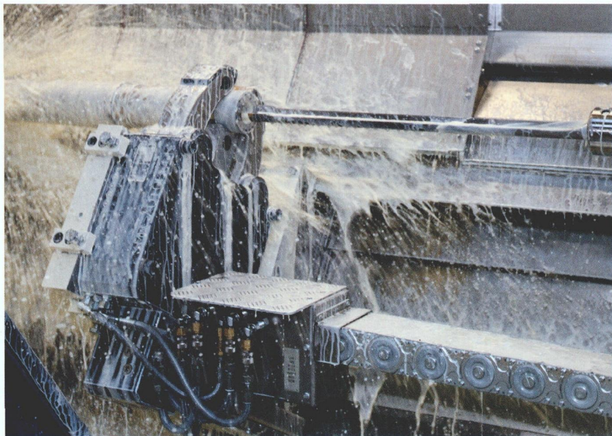
图 1 WFL 全面的内孔加工专业知识，应用于复合加工中心的完整的深孔钻技术，图中配单刃钻头
