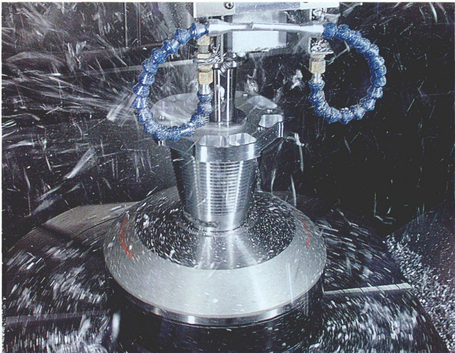
图 1 采用 ATS 冷却润滑技术方案和带有菱形回转式刀片的螺纹铣刀进行锥形铝材工件的 8° 孔切削加工
