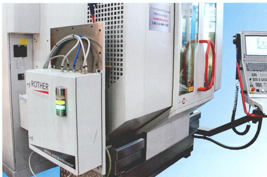
图2 Rother 公司的 ATS 冷却润滑技术方案可通过很少的投入便能顺利集成入机床的自动化系统中
