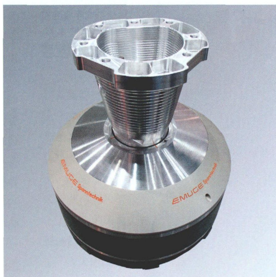
图3 该传动装置外壳在 10 min 内便能完成切削加工, 且无需进行再加工
