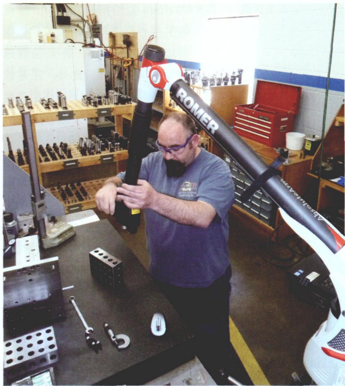
图 1 Clinkenbeard 公司的高级技术专家 Mark Vance 将配备激光扫描仪的七轴便携式手臂定位在被测部件上方，在开始之前将无需归位流程
