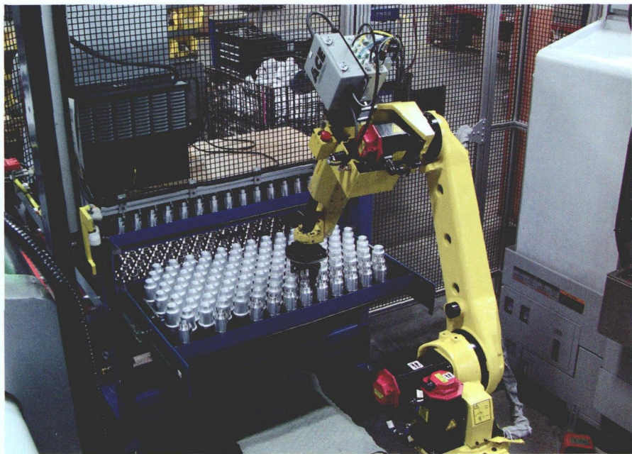
图2 这套抽屉式放料系统用于为加工中心供应冲锻坯料
