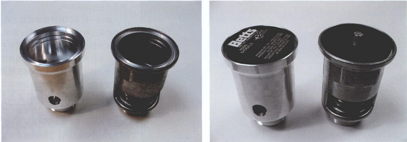
图 4 刚加工出来的阀壳（左上图）和最终装配件（左下）替代了右侧的压铸铝阀壳和最终装配件
