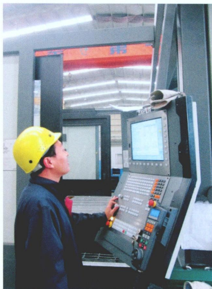
图 2 ZAYER 与 JOBS 的龙门及落地镗铣机床在使用过程中，海德汉 iTNC530 数控系统和光栅尺发挥了核心零部件应用的关键作用
